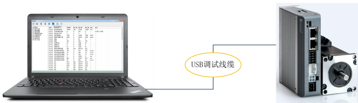
图 4-2 驱动器与 PC 的连接示意图
